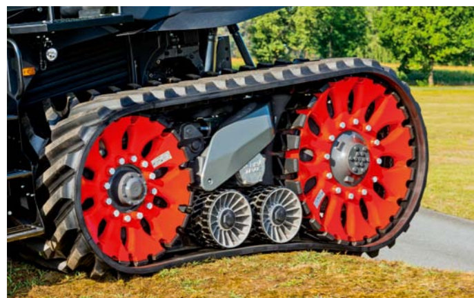
Rýchlosť 40 km za hodinu a hydropneumatické pruženie s dráhou 12 cm sú základné prednosti pásov TerraTrac.
