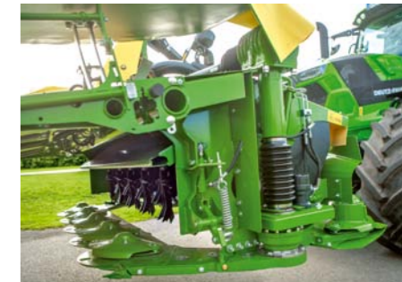
Väčší záber čelnej lišty zvyšuje výkonnosť. Väčší presah medzi čelnou a zadnými žacími lištami skvalitňuje prácu na bočných svahoch a zjednodušuje manévrovanie pri prekážkach.
