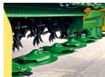
Žacia lišta pozostáva z nosníka SmartCut, rýchlovýmenného systému nožov a ochrany pred poškodením SafeCut.
