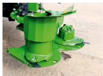
Vonkajší sklopný žací bubon a disk.
