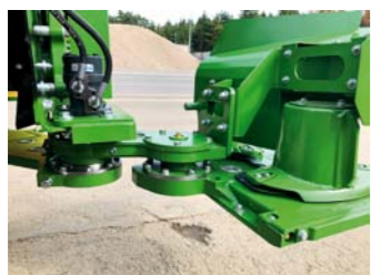
Rozkladanie lišty na plný pracovný záber je hydraulické, ovládané z kabíny traktora.
