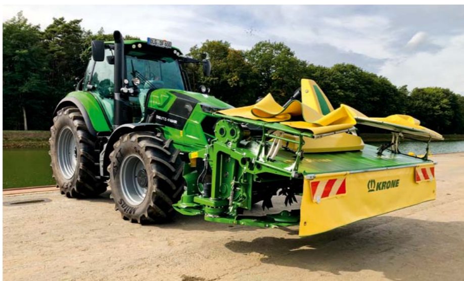
Nové plachty sú predpäté a počas práce jemne vibrujú. To zabezpečuje samočistiacu schopnosť. Automaticky sa sklápajú spolu s okrajovými kotúčmi.
