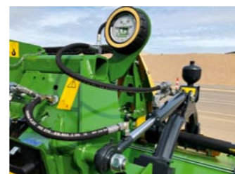
Do nového prípojného rámu je do funkcie zdvíhania lišty integrovaná aj funkcia hydraulického odľahčovania ako súčasť základnej výbavy.
