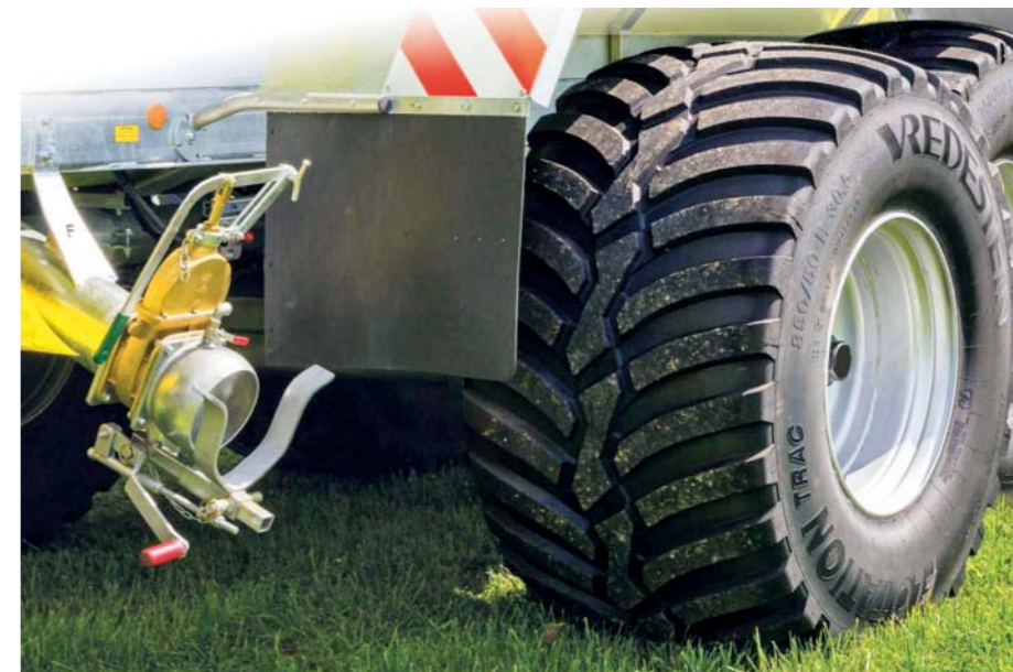
Fliegl dodáva aj systém pre reguláciu tlaku v pneumatikách, ale menšie zhutnenie pôdy dosiahnete aj teleskopicky vysúvateľnou prednou nápravou.
