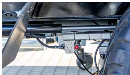
Hydraulickým posuvom náprav po ráme stroja meníte rozloženie hmotnosti podľa aktuálneho stavu.
