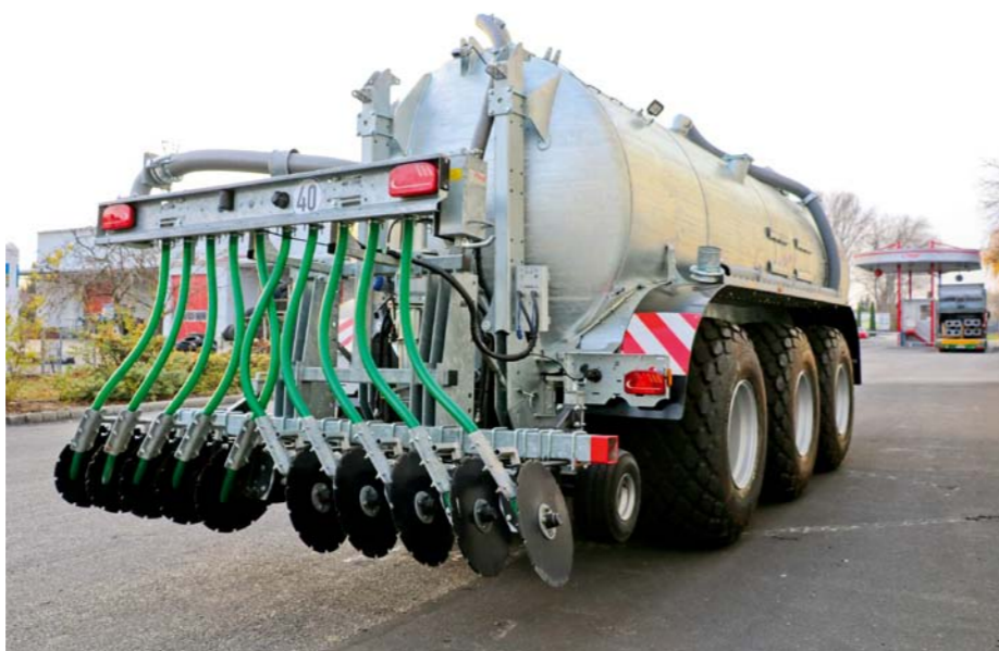
Nový aplikátor Fliegl SSG 30 Vario Disc s pracovným záberom 3 m má disky s priemerom 520 mm.
