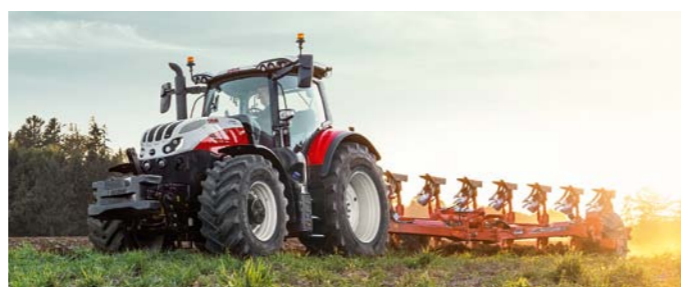
Novinka sa od ostatných strojov v triede odlišuje aj silnejšou nápravou s kolesami s priemerom 2,05 m. Celková povolená hmotnosť traktora atakuje hranicu 15 t. Zadný trojbodový záves udvihne 10 463 kg.
