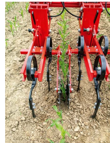
Šetrnosť práce plečky Transformer. Výška rámu 66 cm dovoľuje pracovať aj vo vyšších porastoch.
