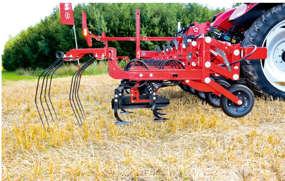
Oporné kolesá vpredu zlepšujú rovnomernosť pracovnej hĺbky.
