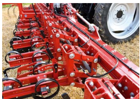
Pracovné orgány sú na hlavnom ráme uchytené prostredníctvom paralelogramu. Hĺbka práce sa nastavuje bez použitia náradia.
