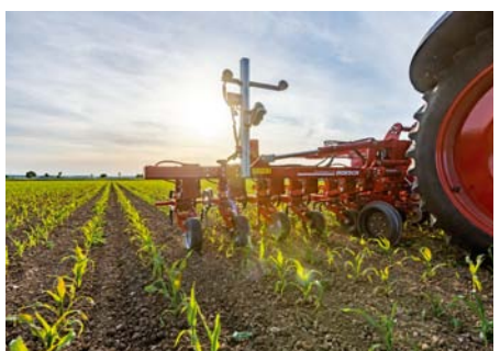
Kamerové navádzanie zvyšuje presnosť a umožňuje pracovať aj za horších svetelných podmienok.
