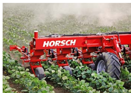
Transformer sa prispôbi medziriadkovej vzdialenosti 15 až 80 cm, teda od obilnín až po kukuricu.
