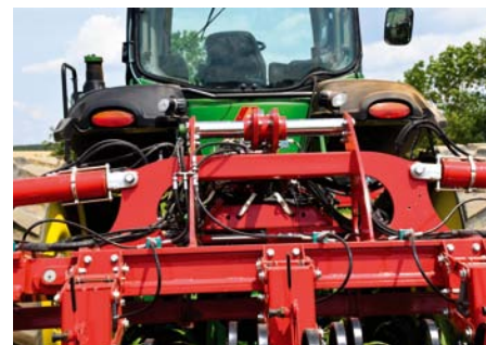
Posuv 45 cm je integrovaný do hlavného rámu.
